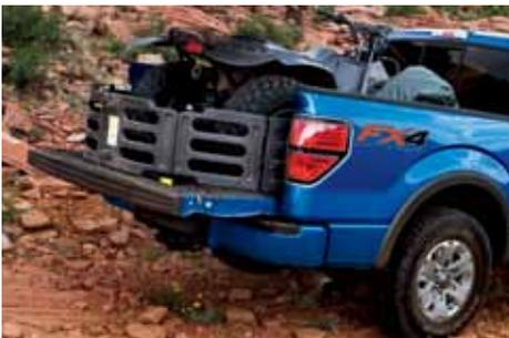
**Un peu plus long...** La rallonge de plateau escamotable<sup>2</sup> se déploie, s'assemble et se fixe à l'aide d'un verrou à tige. Cette barrière robuste vous permet de transporter de longues charges lorsque le hayon est rabattu ou de maintenir en place de petites charges contre le hayon relevé.
