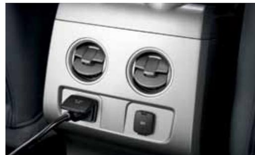
**Branchez vos appareils électroniques.** À l'arrière de la console centrale<sup>1</sup>, une prise de courant de 110 V et une prise de 12 V vous permettent de recharger vos appareils portables.
