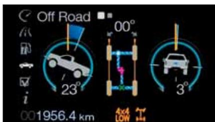
**Suivez l'action!** Notre écran de productivité ACL vous permet de surveiller l'angle de tangage, l'angle d'inclinaison latérale et l'orientation des roues grâce à son affichage hors route exclusif dans la catégorie<sup>1</sup>.
